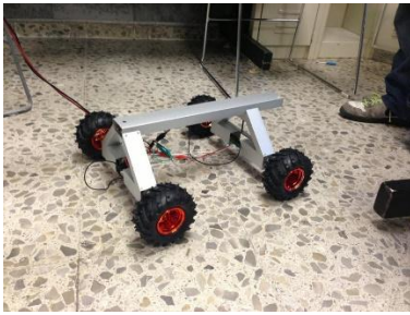
Fig. 1. Base con motores y llantas.
