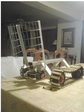
Fig. 3. Robot ensamblado con gripper
